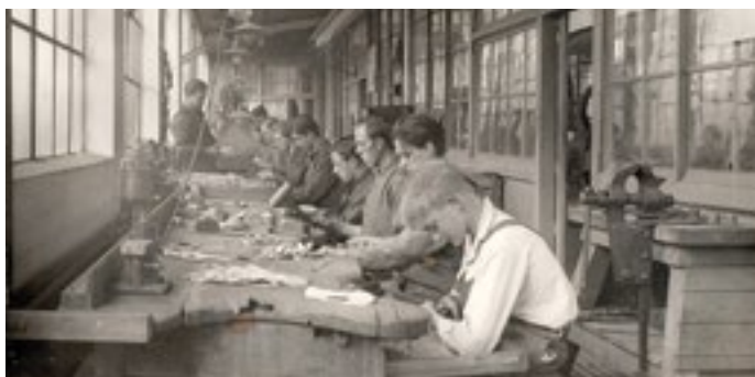
Bag glasvæggen til højre aner man de store bestikpresser, der grovfremstillede bestikdelene, som så fædiggjordes af sølvsmedene og lærlingene.
